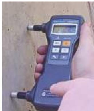
Схема испытаний и распространение ультразвуковой волны в конструкции в зоне трещины показаны на ил. 29 и 30. Испытание дает качественную оценку глубины дефектов и усредненное значение их глубины. При испытании ультразвуковым прибором УК 1401, в функциях которого заложено определение глубины трещин по представленной выше методике, время испытаний существенно сокращается.
