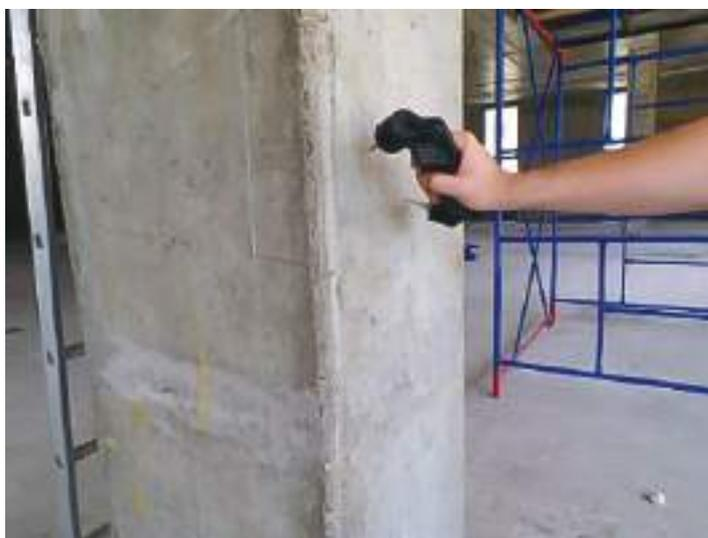
Ил. 24. Определение прочности бетона методом поверхностного прозвучивания в монолитной железобетонной колонне
