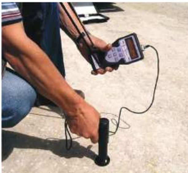
Ил. 19. Испытания по определению прочности бетона прибором ИПС-МГ4
