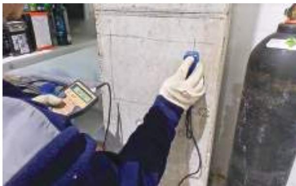
Ил. 9. Определение диаметра арматуры прибором «Поиск»
