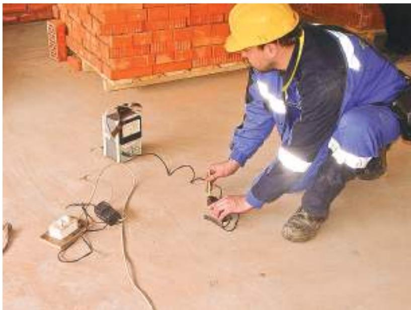
Ил. 10. Определение нахождения арматуры, ее диаметра, защитного слоя бетона приборами ИПА-МГ4.01, ИЗС-10Н в конструкции железобетонной плиты
