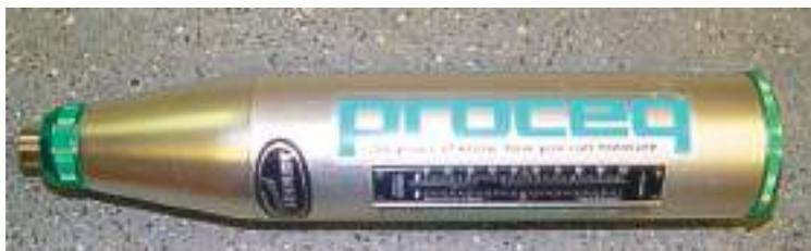
Ил. 7. Прибор-склерометр молоток Proceq
