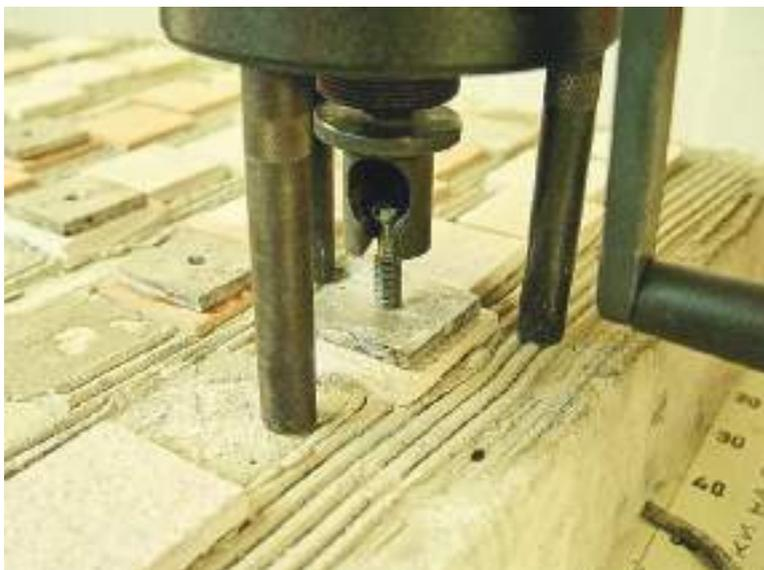
Ил. 20. Соединение прибора ПОС-МГ4 с диском и приклеенной пластиной
