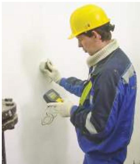
Ил. 31. Измерение влажности поверхности бетона прибором ВИМС-2.2
