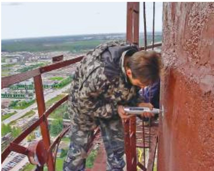
Ил. 8. Определение прочности бетона методом упругого отскока прибором-склерометром молотком Шмидта
