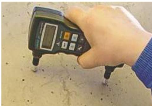
Ил. 28. Испытание по определению прочности бетона в конструкции без трещин поверхностным методом ультразвуковым прибором УК 1401
