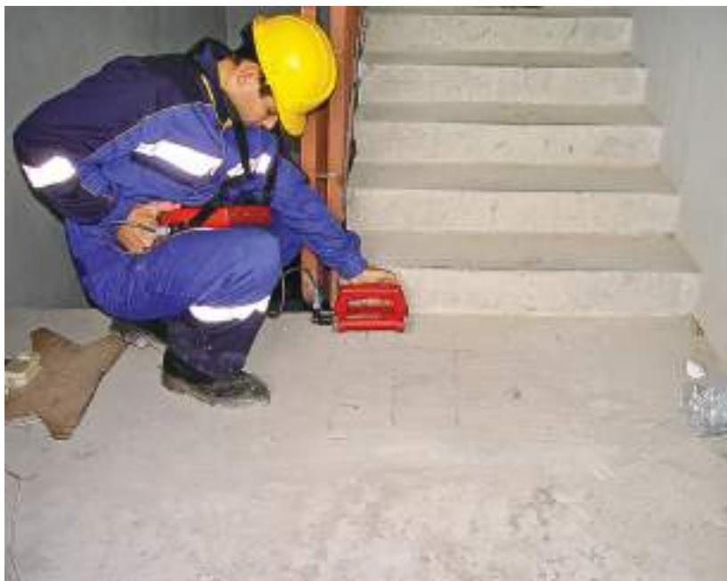
Ил. 13. Определение нахождения арматуры, ее диаметра, защитного слоя бетона прибором «Фероскан»
