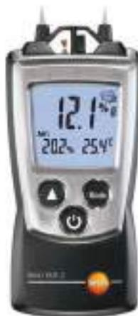
Ил. 32. Прибор Testo 606-2 для измерения влажности строительных материалов (бетон, кирпич, стяжки пола и штукатурки стен из цементного раствора)
