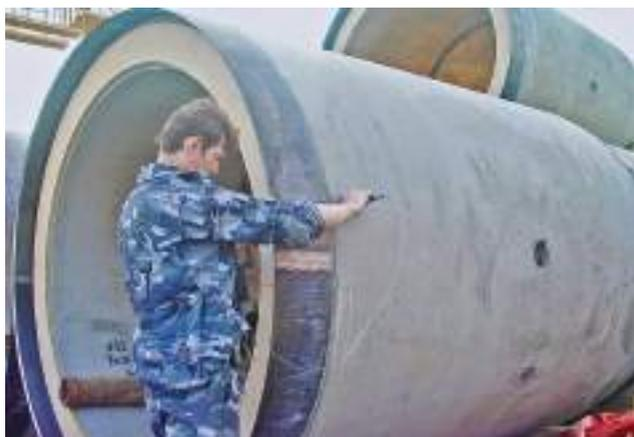
Ил. 22. Испытания методом сквозного прозвучивания
