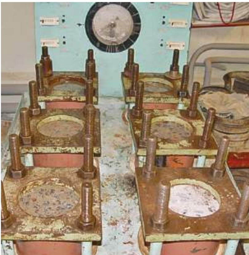
Ил. 35. Завершение испытания методом мокрого пятна
