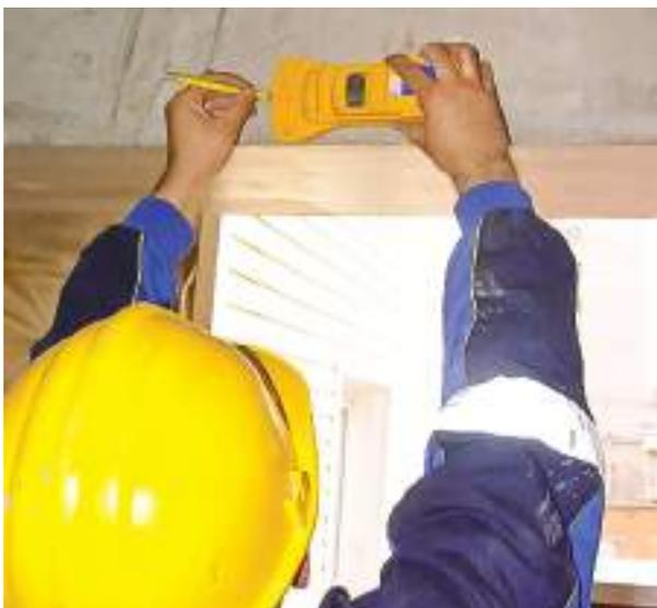
Ил. 12. Определение нахождения арматуры, ее диаметра, защитного слоя бетона прибором Elcometer
