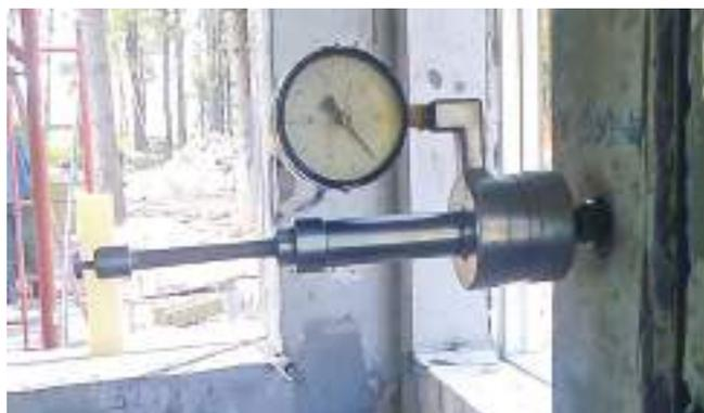
Ил. 5. Определение прочности бетона в железобетонной конструкции стены прибором ГПНС-4
