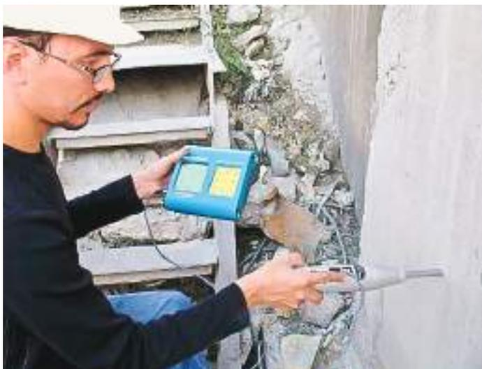
Ил. 16. Испытания по определению прочности бетона прибором Silver Schmidt
