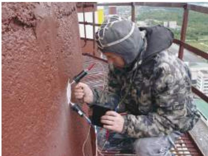
Ил. 23. Определение прочности бетона методом поверхностного прозвучивания в монолитной железобетонной стене
