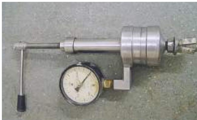
Ил. 4. Прибор для определения прочности бетона ГПНС-4
