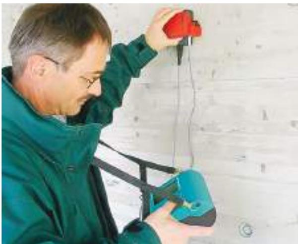
Ил. 11. Определение нахождения арматуры, ее диаметра, защитного слоя бетона прибором Profometer5+ в конструкции монолитной железобетонной стены
