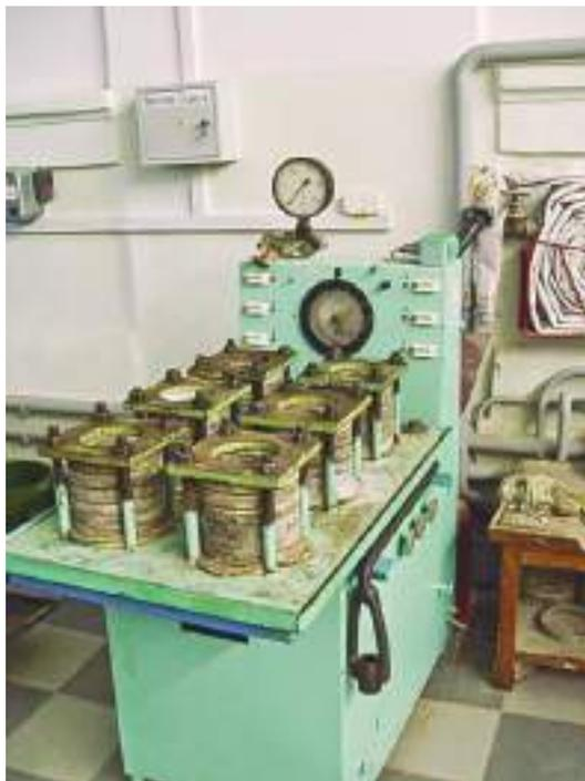
Ил. 34. Стационарная лабораторная установка для определения водонепроницаемости методом мокрого пятна
