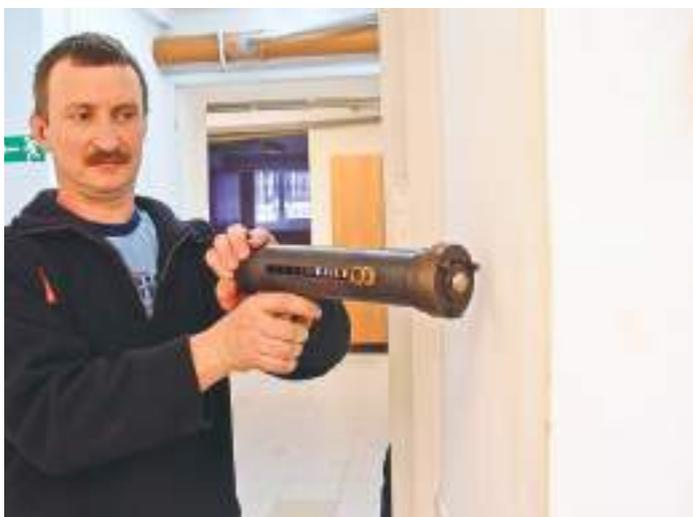
Ил. 17. Определение прочности бетона прибором, разработанным в ЛИСИ (СПбГАСУ)
