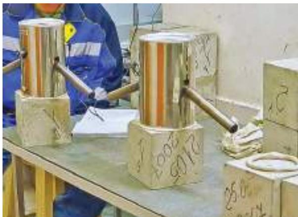
Ил. 37. Определение водонепроницаемости бетона по образцам прибором АГАМА-2Р
