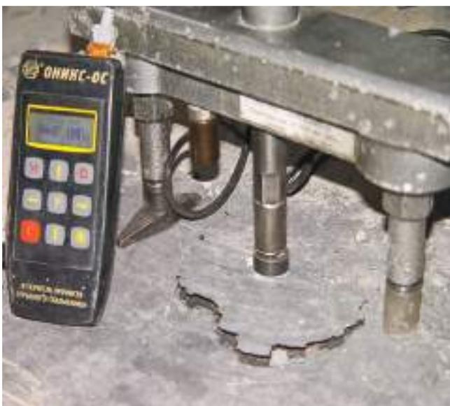
Ил. 3. Определение прочности бетона методом отрыва со скалыванием прибором ОНИКС-ОС в железобетонной плите перекрытия
