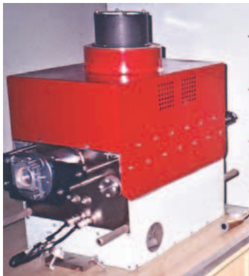
1. Излучатель лазерной установки ФЛИП-1 (ширина 320 мм)
