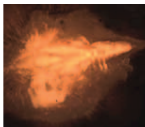
4. Микрофотографии лазерных кратеров на поверхности копоти, образованных при различных расстояниях от линзы L: a – 15 см; б – 16 см; в – 17 см; г – 19 см
