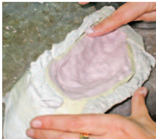
2. Реконструкция недостающей части скульптуры с использованием Balsite
