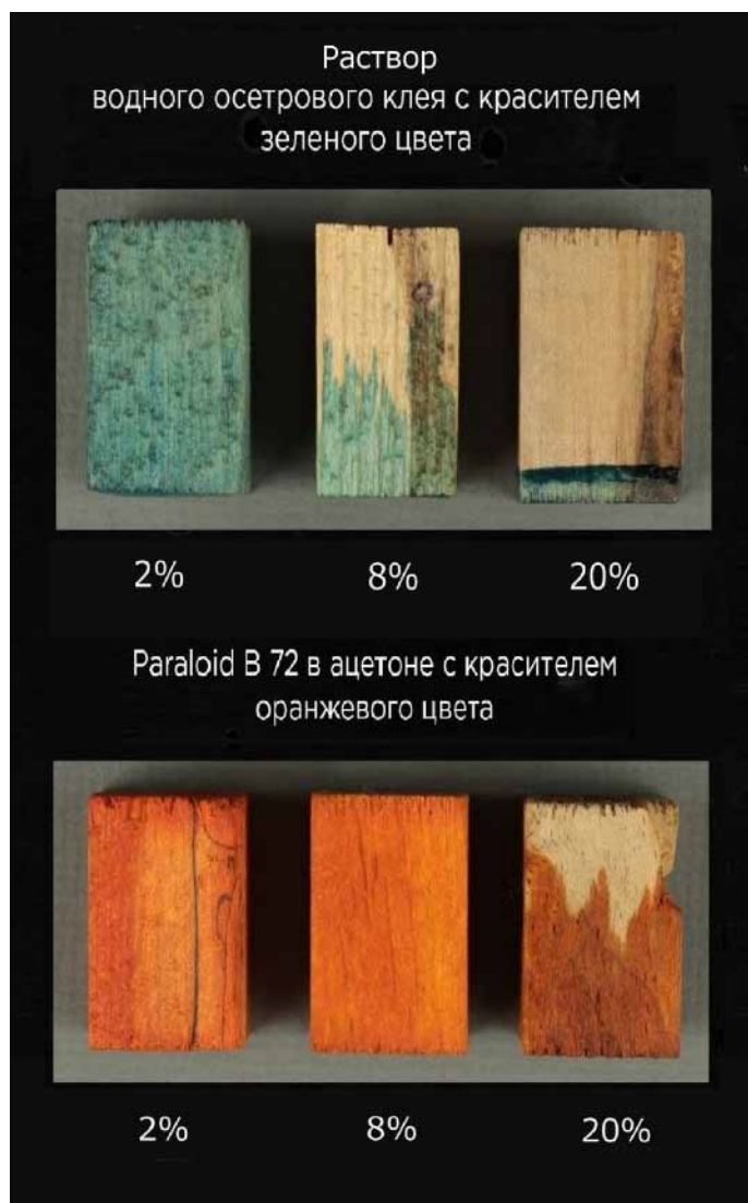
9. Тестирование проницаемости растворов консолидатов в древесину
