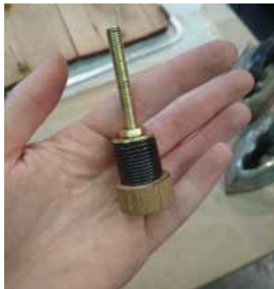
19. Винт с пружиной для регулировки силы прижатия
