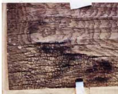
6. Поражение древесины различными видами грибов
