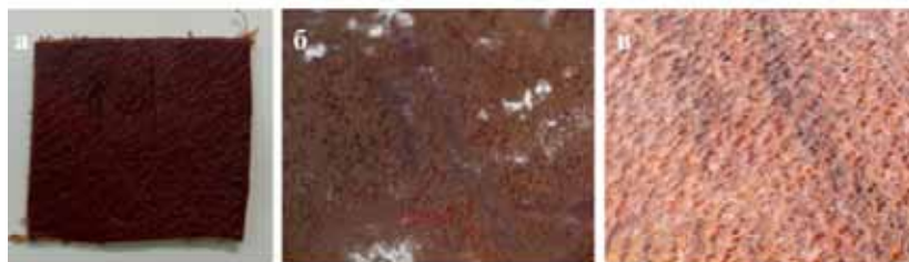
9. Снимок оптического микроскопа фрагмента кожи, зараженного микромицетом Aspergillus niger :
